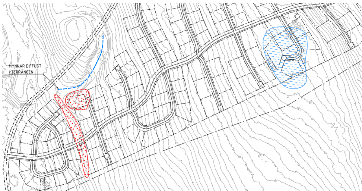
Figur 9 - Utdrag ur geokarta där röda ytor är områden med blockterräng och blå ytor områden med tunnare lager torv.
